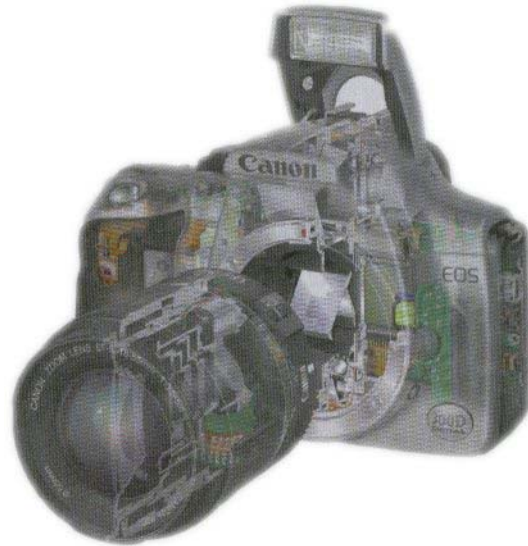
Un juego de espejos situado en el objetivo hace que una cámara sea réflex
