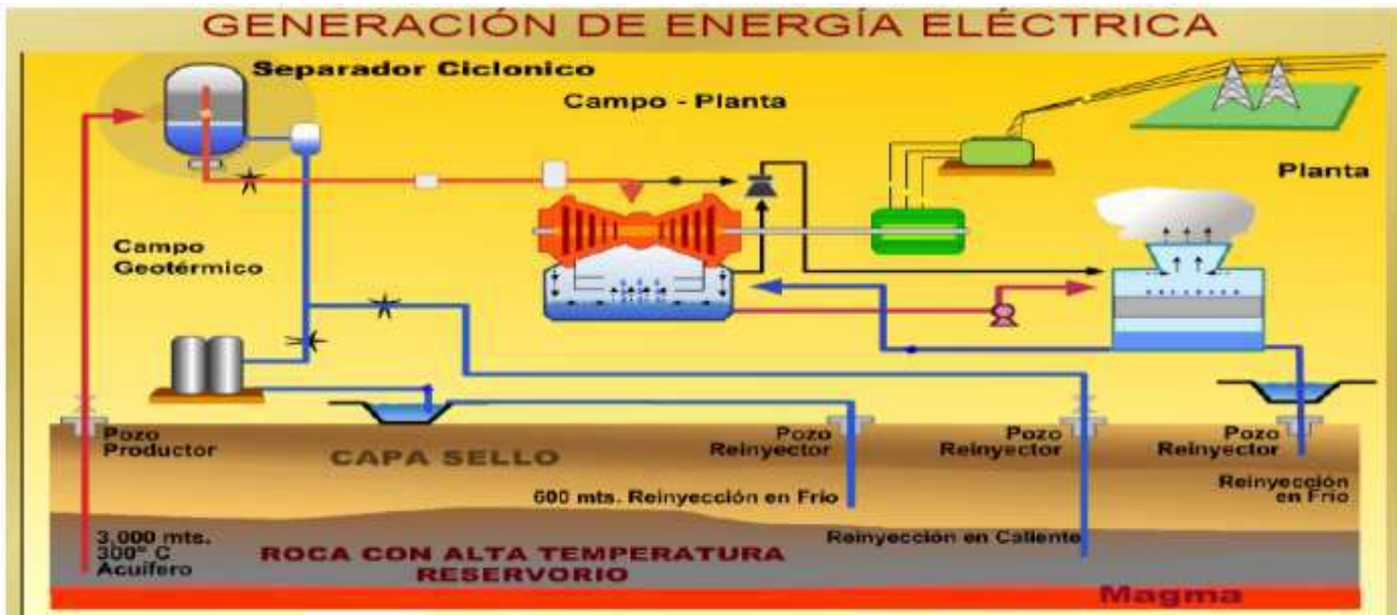
Esquema de una central geotérmica. Fuente: http://www.usk.edu.pl
